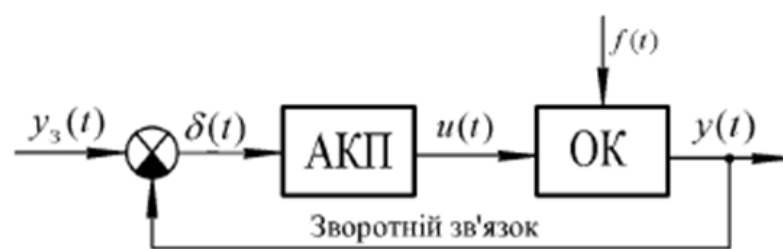
Рис. 1.6. Структура САК при керуванні за відхиленням
